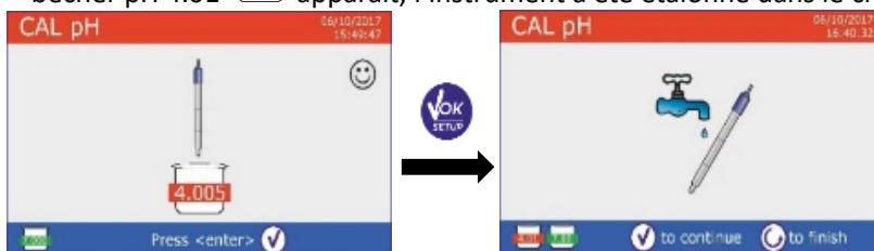
Pour une courbe d'étalonnage de deux points appuyer sur pour terminer le processus d'étalonnage et passer en mode mesure.
