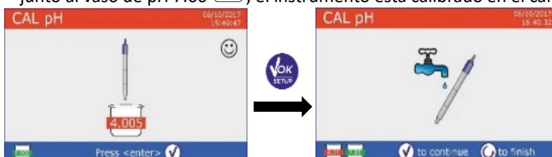
Para una curva de calibración de dos puntos, presione para finalizar el proceso de calibración y volver al modo de medición.
